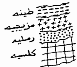
شكل رقم (٢٣) مقطع رأسي للتربة
